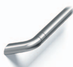
HR64* Pyöreä, kaareva Täyttää EN81-71 kategoria 1:n vaatimukset Pintamateriaalit: Harjattu ruostumaton teräs (F) Peilikiillotettu ruostumaton teräs (H) Kultaharjattu ruostumaton teräs (SS1)
