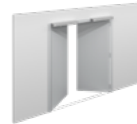
Kaksilehtinen ovi päälaitte/sivulaitte-toiminta Kaksi sähköisesti yhdistettyä moottoria ja vakiovarsi työnnettävään oveen
